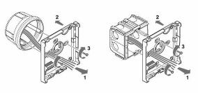
Mini Audio Handsfree Montage der Gegensprechanlage auch an vorhandener Unterputzdose möglich
