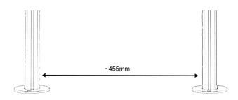
Zur Verschraubung sind M10 Schwerlastdübel zu Verwenden, diese werden nicht mitgeliefert.
