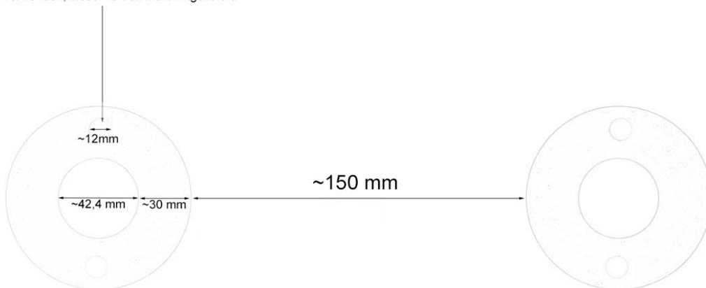
Fussplatte entfällt bei Montageart zum Einbetonieren
