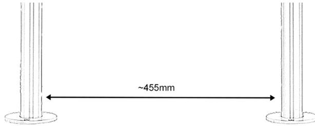
Zur Verschraubung sind M10 Schwerlastdübel zu verwenden, diese werden nicht mitgeliefert.
