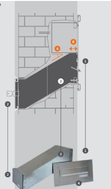
Seitenansicht eines schrägen Durchwurfkastens mit einer Frontplatte aus Edelstahl
