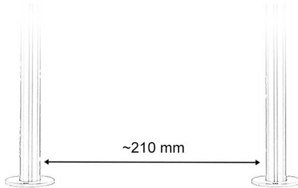
Zur Verschraubung sind M10 Schwerlastdübel zu verwenden, diese werden nicht mitgeliefert.
