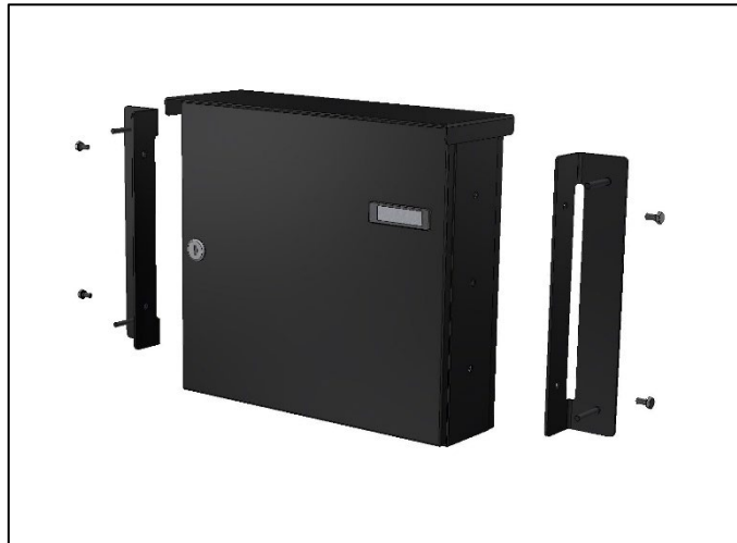
Abbildung 28 – Montage der Haltewinkel am Briefkasten
