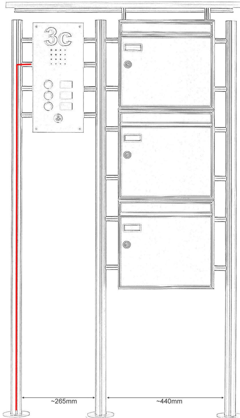
Zur Verschraubung sind M10 Schwerlastdübel zu verwenden, diese werden nicht mitgeliefert.
