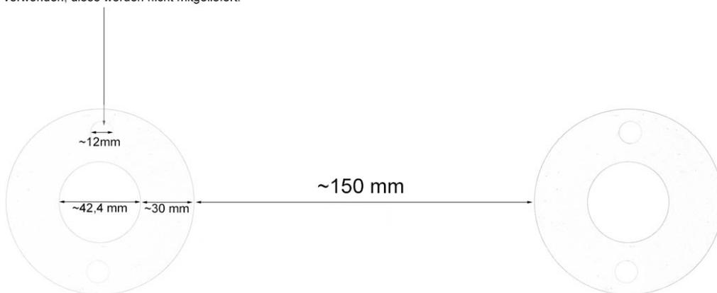
Fussplatte entfällt bei Montageart zum Einbetonieren
