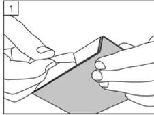
Die zu beklebende Oberfläche muss trocken, frei von Staub, Öl, Oxiden, Trennmitteln und anderen Verunreinigungen sein. Lassen Sie die Klebestelle nach der Reinigung kurz abtrocknen (abblühen) und entfernen Sie dann die Schutzfolie vom Klebeband auf dem Zeitungsfachverschluss.
