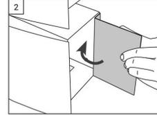
Setzen Sie den Verschluss vorsichtig wie gezeigt an die äußere Kante des Zeitungsfachs, so dass die Kante des Verschlusses bündig mit der des Zeitungsfachs abschließt. Klappen Sie nun den Verschluss um 90° ein.
