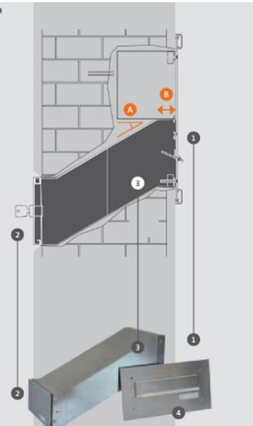
Seitenansicht eines schrägen Durchwurfkastens mit einer Frontplatte aus Edelstahl
